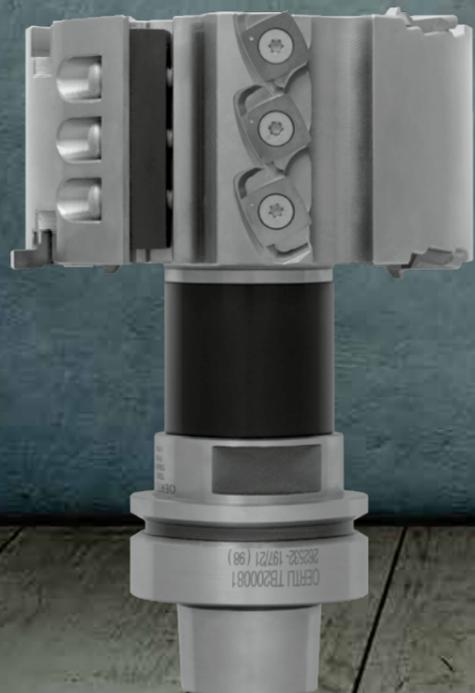
**Mit dem Hybrid-Falzfräser lassen sich zahlreiche Bearbeitungen an Massivholztüren und -zargen durchführen.**
